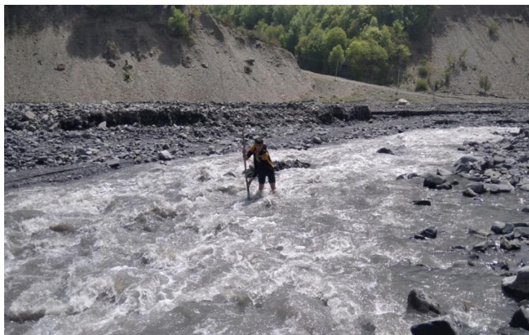
Şəkil 3. Ekoloji Coğrafiya şöbəsinin əməkdaşı Elvin Qarayev Dəmiraparançayın eni və dərinliyini ölçür. Aprel 2024, ( 41°02'32" N, 47°55'03" E ) D.s.h=1258 m.
